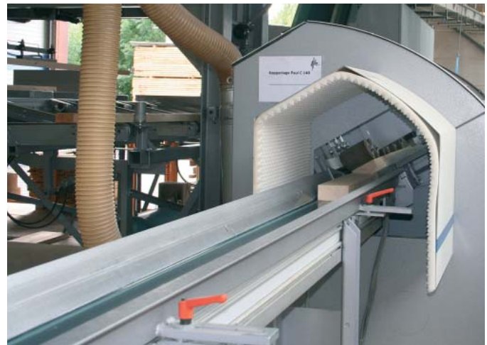
... gemäß Produktionsziel in der Paul-Kappsäge C 140 optimiert zugschnitten werden
